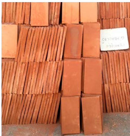
Håndstrøgne italienske gulvtegl efter brænding.
