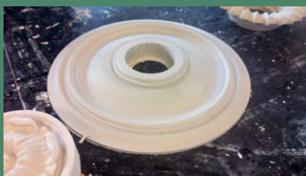
Hvis stukrosetterne eller stukanten er skadet, er det er muligt at få repareret og støbt nye kopier af de eksisterende stukkanter og rosetter.
