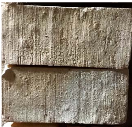
Håndstrøgne gulvtegl kan både lægges på knas i sand og fuges med tapetklister eller med en fuge på ca. 7 mm.
