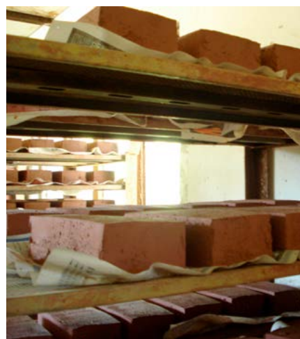
Håndstrøgne mursten lagt til tørre inden brænding.
