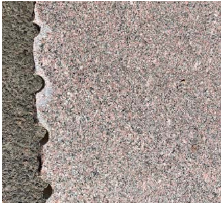
Granitblokkene udskæres i dag på store save med diamantklinger inden den videre forarbejdning.
