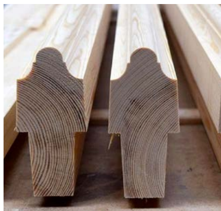
Vinduernes karme og rammer skal helst laves af spejlskåret kernetræ. Kernen er træstammens inderste og ældste årringe, hvor træets celler er rige på olie-, tjære- og harpiksstoffer.
