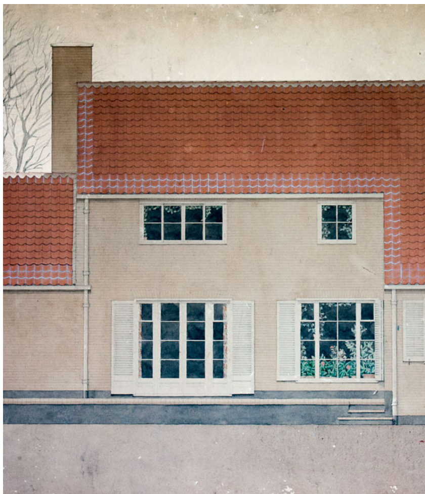
Tegningen viser, at de yderste rækker tagsten langs tagfod og gavle er forskælet. Tagstenene blev overstrøget med mørtel udefra og nogle gange kalket, en løsning, der bl.a. ses på mange ældre huse i Skagen. Akvarel af arkitekt Thomas Havnings eget hus i cottagestil fra 1934.
